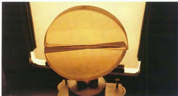
*Maquette à échelle réduite du mélangeur de faisceaux (source: REOSC, F)*
