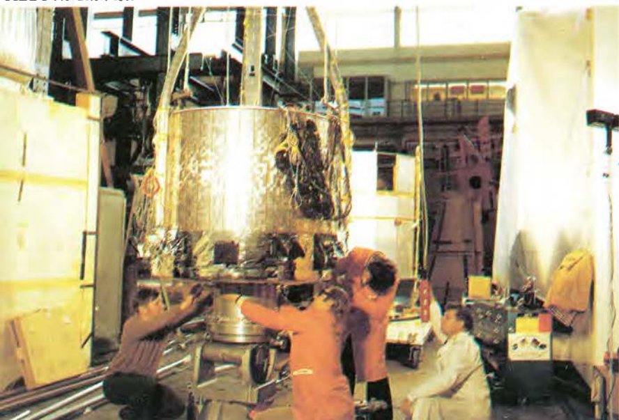
ISEE 2 vibration test
